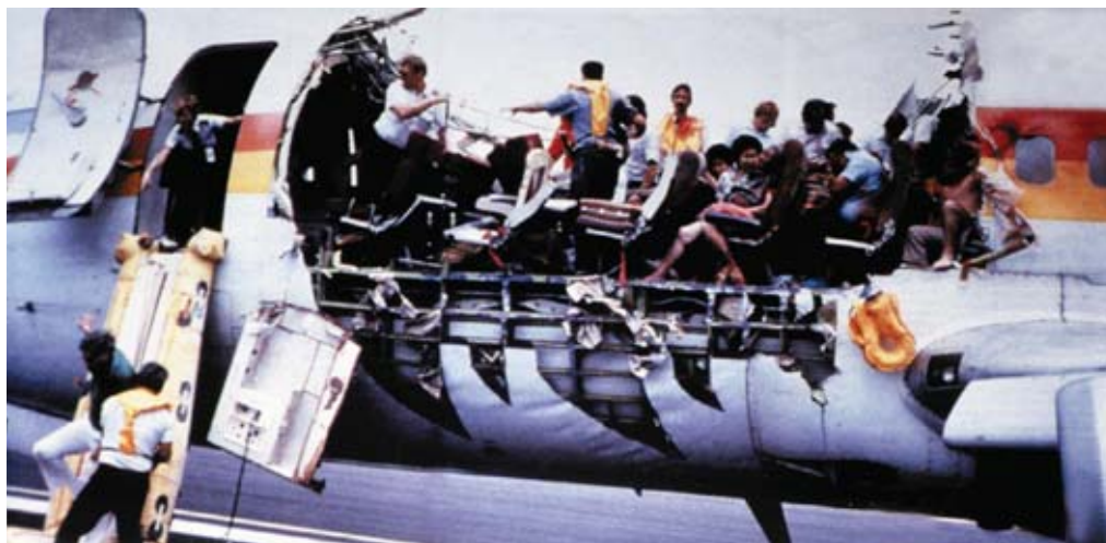
Rys. 1. Odpadnięcie górnej części pokrycia kadłuba samolotu w czasie podejścia do lądowania (Foto Internet)
